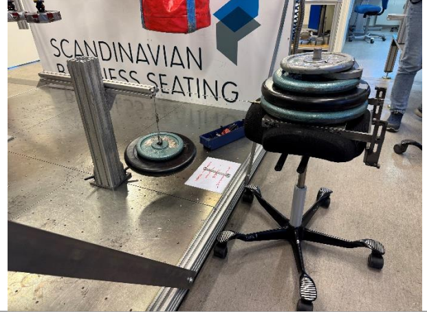
21. Out stop test
